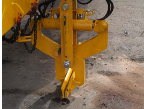
Particularidades de la pinza tira / posiciona vías
